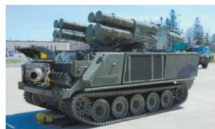
“阿达茨”近程防空导弹系统,由瑞士和美国联合研制,是防空、反坦克两用武器系统。它具有独特的双用途战斗部,即一种内腔装有聚能药形罩和高爆炸药,外壳采用预制破片壳体的结构。
