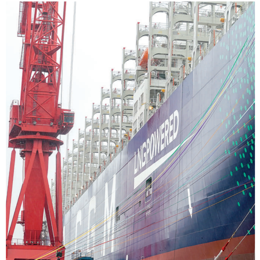
5月26日,载箱量达23000TEU的超大型双燃料集装箱船“达飞·特罗卡罗”号,在上海命名交付给法国达飞海运集团。该船入级法国船级社,总长399.9米,型宽61.3米,航速22节,载重量近22万吨,是当之无愧的“海上巨无霸”,将于5月29日从中国驶往北欧,投入到达飞亚欧航线FAL1运营中。图为“达飞·特罗卡罗”号。 新华社发
