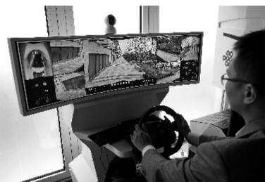
在河北省雄安数字交通实验室，技术人员对无人驾驶汽车进行远程操控。
