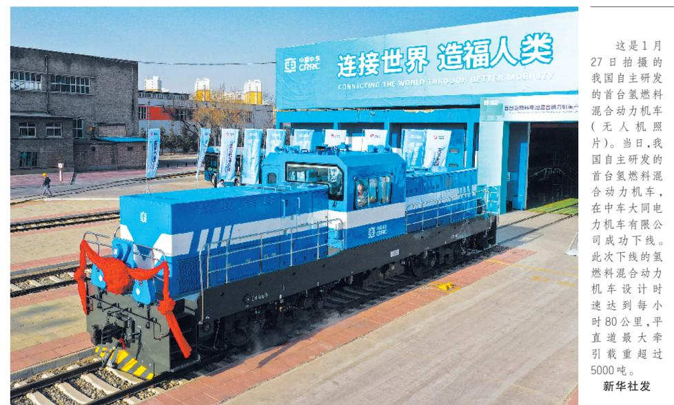
这是1月27日拍摄的我国自主研发的首台氢燃料混合动力机车(无人机照片)。当日,我国自主研发的首台氢燃料混合动力机车,在中车大同电力机车有限公司成功下线。此次下线的氢燃料混合动力机车设计时速达到每小时80公里,平直道最大牵引载重超过5000吨。 新华社发
