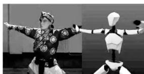
用户想要获得完全的沉浸感,真正“进入”虚拟世界,动作捕捉系统是必须有的。在人体的关键部位设置追踪器,由系统捕捉追踪器位置,再经过计算机处理后得到空间坐标数据;数据被计算机识别后,可以应用在动画制作、步态分析、生物力学、人体工程等领域。
