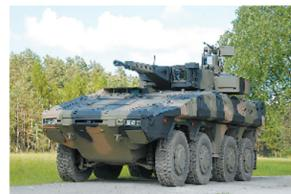
“拳师犬”的高防护性也被各国买家看重。其车体防护采用陶瓷混合模块化装甲，在起到较好防护作用的同时，还可以根据不同作战任务加装各类外部装甲，提高了作战适应性；车体底部的三层V型钢装甲结构，在反坦克地雷袭击频发的中东地区，可以减少士兵受到的爆炸冲击；配备新型双人模块化炮塔系统，车内士兵可以使用遥控型机关炮射击，安全性又增加几分。
