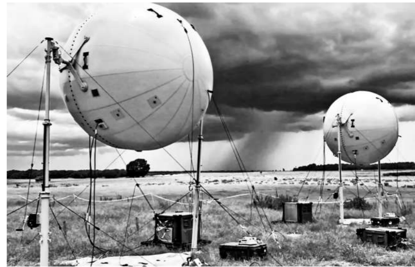
“下一代对流层散射通信系统”的球形充气式可展开天线。
