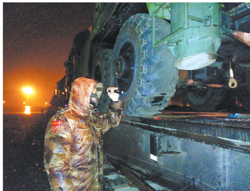
西部战区某调度中心格尔木军代室克服恶劣环境影响,坚持高标准严格要求,多次圆满完成军事运输投送保障任务。图为该军代室军代表夜间检查部队装备捆绑加固情况。 张勇摄
