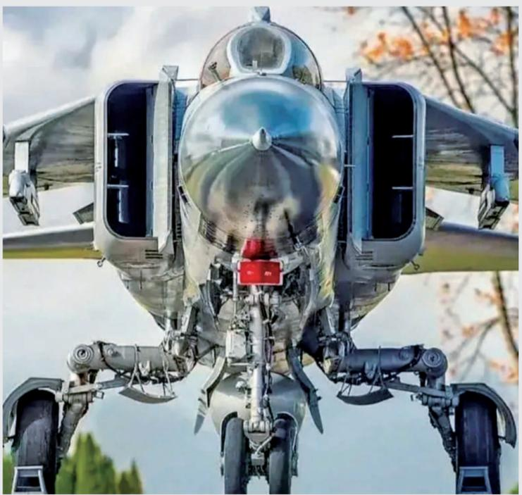
米格-23战斗机的“蟹爪”式起落架。
