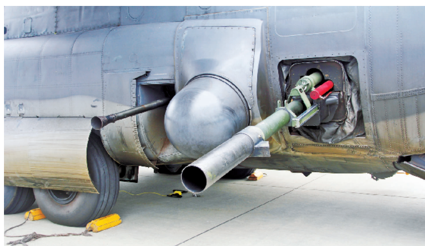
AC-130上的105毫米加农炮，其旁边分别为火控雷达和40毫米机炮
