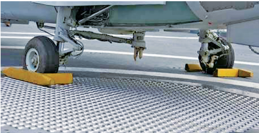
“鱼叉”助降系统由直升机上的“鱼叉”和舰上的格栅组成
